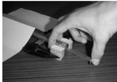
fig.3 : évaluation de la raideur d'un ressort réel
